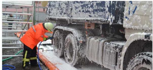
Durch die flexible Randbegrenzung ist ein ruckfreies Einfahren in die Wanne ohne Verlust an Desinfektionsmittel möglich.
