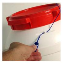
I. Lorsque le fût est scellé, arracher le plomb et le retirer des encoches.
