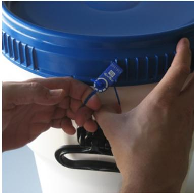
1. Sollte ein Fass verplombt sein, brechen Sie die Plombe durch und ziehen diese aus den Siegelöffnungen.
