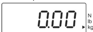
⇒ Ligue a balança com a alavanca auxiliar suspensa. Pressione e mantenha pressionado o botão **Unit** (cerca de 3 s) até aparecer no visor "**CAL**".
