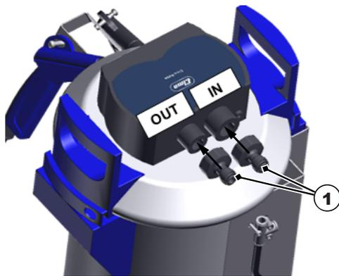
1. Avvitare saldamente 2 collegamenti a vite (1) agli allacciamenti **IN** e **OUT**. Avvitare l'altro collegamento a vite all'allacciamento dell'acqua.
