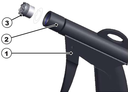
3. Inserte la boquilla (3) que desee enroscándola con la llave de montaje.
