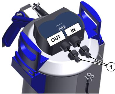
1. Die 2 Verschraubungen (1) an die Anschlüsse **IN** und **OUT** handfest anschrauben. 1 weitere Verschraubung an den bauseitigen Wasseranschluss anschrauben.
