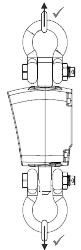
**Usar só aqueles elementos para pendurar carga que garantem suspensão unipontoada e livre pendura da balança.**
