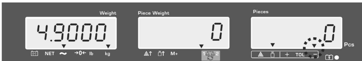
Projeção do sinal de tolerância ▼ quando a massa do material pesado está dentro da tolerância ajustada:
