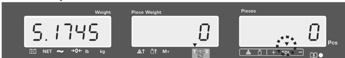
Projeção do sinal de tolerância ▼ quando a massa do material pesado está acima da tolerância ajustada:
