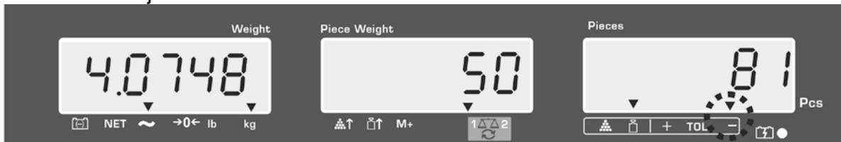
Projeção do sinal de tolerância ▼ quando a massa do material pesado está dentro da tolerância ajustada:
