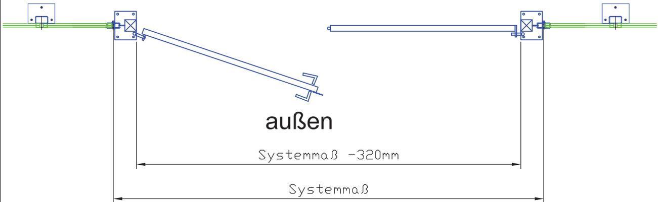
Die Falle vom Rohrrahmenschluss ist drehbar, und somit rechts und links einsetzbar.
