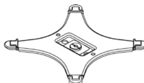
Wspornik kwadratowej płytki wagi (modele o działce elementarnej d = 0,01 \text{ g}/0,1 \text{ g} )
