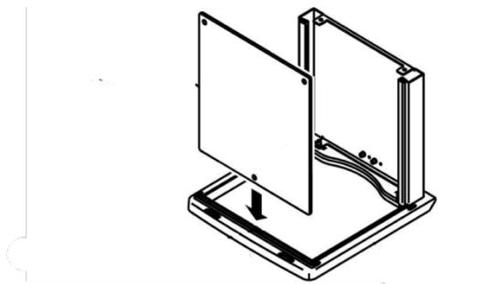
Veiller à ce que le point de fixation soit placé sur le cadre dans le trou du panneau frontal.
