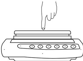
Par pression avec le doigt contrôler la réaction de l'affichage de poids.
