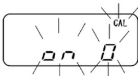
Aucun objet ne doit se trouver sur le plateau de pesage.
