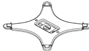
Soporte del plato cuadrado (modelos con rango de lectura d = 0,01 \text{ g}/0,1 \text{ g} )
