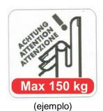
⇒ No sobrepasar la carga nominal admitida de la grúa (grúa puente), de la balanza de grúa o de cualquier dispositivo de enganche de carga de la balanza de grúa.
