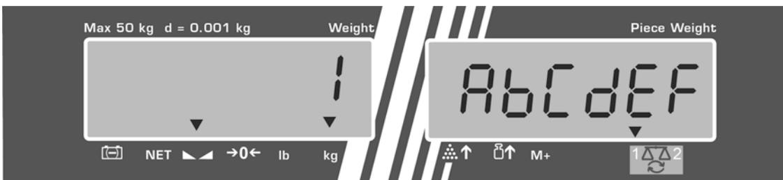
⇒ Eingabe mit **TARE**-Taste bestätigen. Die Daten (Tarawert, durchschnittliches Stückgewicht, Artikelbezeichnung) werden unter der ausgewählten Direkttaste gespeichert.
