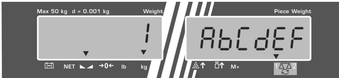
Die Anzeige wechselt in den Zählmodus, der hinterlegte Tarawert z. B. 500 g und das durchschnittliche Stückgewicht z. B. 10g /Stck. werden angezeigt.
