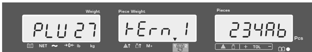
⇒ Eingabe mit **TARE**-Taste bestätigen. Die Daten (Tarawert, durchschnittliches Stückgewicht, Artikelbezeichnung) werden unter der eingegebenen PLU-Nr. gespeichert. Durch Aufrufen der entsprechenden PLU-Nr. können die Daten jederzeit abgerufen werden.
