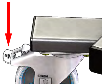
Fig. 84: activar el freno de estacionamiento
