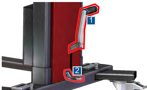
Fig. 11: Lyftning och sänkning
