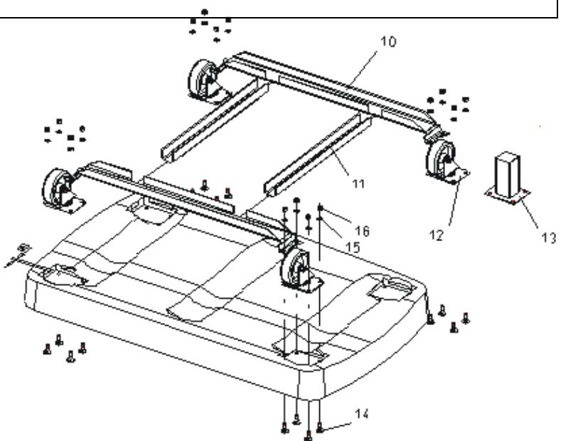
Gire el contenedor, meta por dentro los tornillos en los orificios hasta que el cuadrado de los tornillos esté totalmente metido en el plástico.
